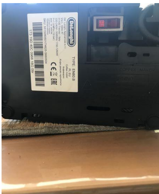
DE SCHAKELAAR KAN IN DIT TYPE HEEL GOED WEGGEWERKT WORDEN IN DE HOLTE AAN DE ONDERKANT.
